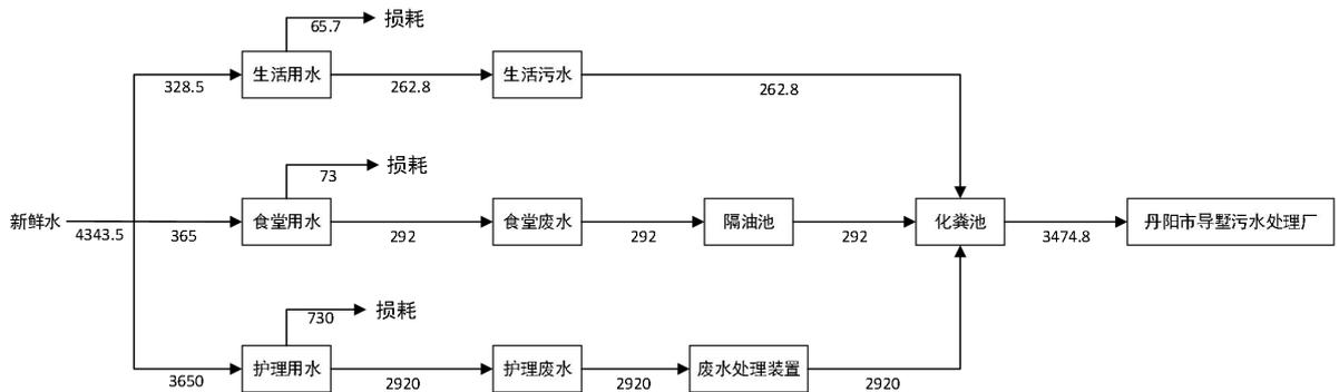
图 2-1 本项目水平衡图 (t/a)
